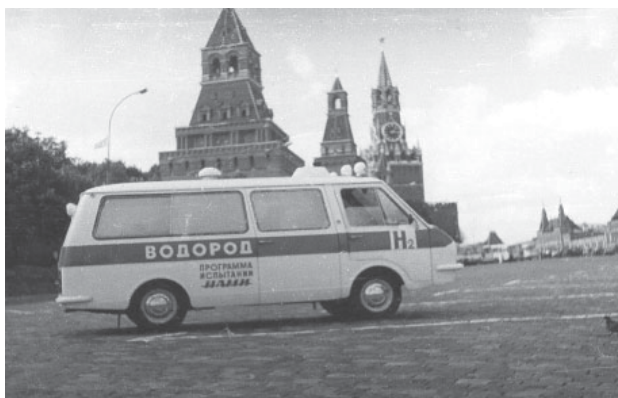
Рис. 4. Микроавтобус РАФ 22031, работающий на бензоводородных топливных композициях
